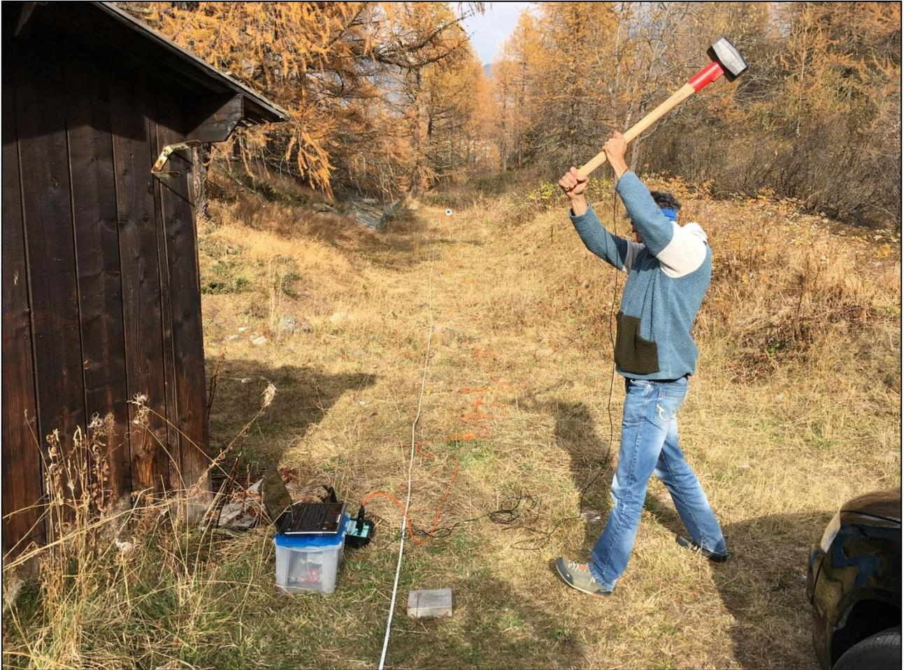
Figura 12. Esecuzione dell'indagine sismica in sito
