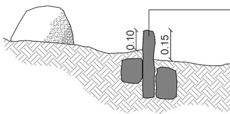
Pietre esistenti in loco utilizzate per gli elementi verticali e di sostegno
